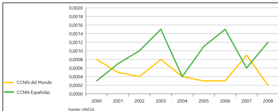
Figura 10. Evolución del indicador de funcionamiento del sistema auxiliar de agua de alimentación de las centrales nucleares españolas y de las centrales que participan en el sistema WANO. Este sistema debe ser redundante de modo que el índice se obtiene dividiendo por el número de sistemas redundantes la relación entre los tiempos de indisponibilidad de los componentes y el tiempo que el sistema redundante ha de estar operable. La situación es tanto mejor cuanto más pequeño es el indicador de funcionamiento.
